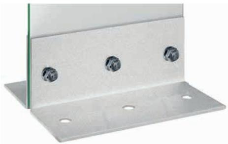
Die Winkel für die unterflurmontierten Außenstelen werden aus 10 mm starken feuerverzinkten Stahl gefertigt. Die Winkel besitzen jeweils am vertikalen und horizontalen Schenkel je nach Breite 3 oder mehr Lochbohrungen ( $\varnothing$  20 mm/14 mm). Die Verbindung erfolgt mit Gewindestangen und Hutmuttern aus Edelstahl.
