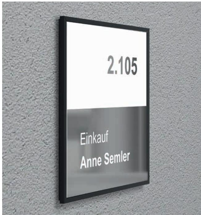
Die nahezu rahmenlose und sehr flache Bauweise zeichnen die Schilder der New Age Serie aus. Das 2-teilige Schild besteht aus einem Aluminiumprofil in Silber oder Schwarz eloxiert mit seitlichen Führungsschienen und einer 2 mm starken Acrylglass-Abdeckung, die an dem oberen, herausnehmbaren Rahmenteil befestigt ist. Aufgrund der entsprechend eingefrästen Kanten der Acrylglasscheibe ist diese flächenbündig mit dem Aluminiumrahmen.
